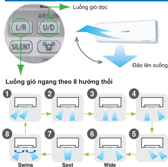
Bằng sự điều khiển độc lập của cánh hướng gió phải và trái, luồng gió hướng từ bên phải và bên trái được kiểm soát riêng biệt. 8 kiểu luồng gió khác nhau được cài đặt.
