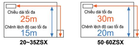
Lắp đặt máy điều hòa cho nhà 3 tầng sẽ dễ dàng hơn với khả năng hỗ trợ kết nối đường ống dài.
