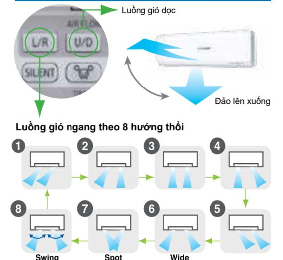
Bằng sự điều khiển độc lập của cánh hướng gió phải và trái, luồng gió hướng từ bên phải và bên trái được kiểm soát riêng biệt. 8 kiểu luồng gió khác nhau được cài đặt.
