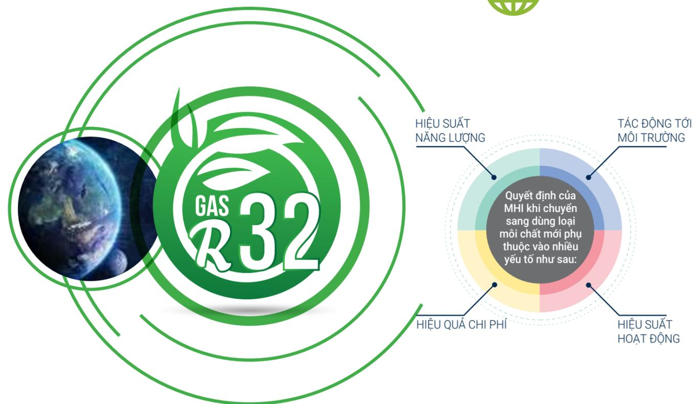
Môi chất lạnh R32 không chứa chất gây suy giảm tầng Ozone. Và chỉ số làm nóng lên toàn cầu chỉ bằng 1/3 so với môi chất lạnh R410A và R22.
